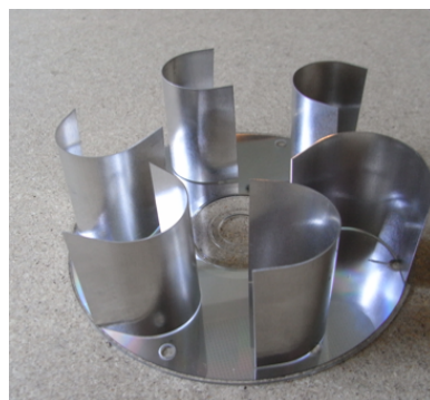
Eine mögliche Form der Schaufeln, es sind auch andere Formen möglich
