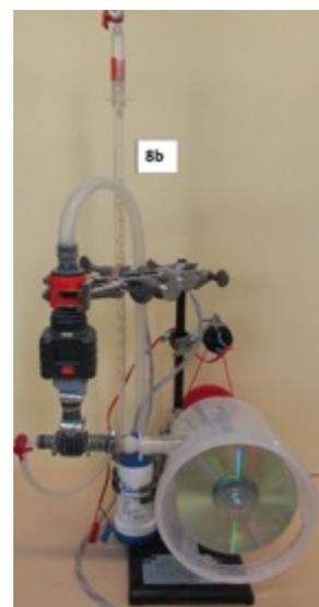
Abb4 Turbine mit Steigrohr als Druckmesser
