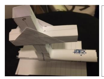
Höhe des Turms 10 cm Breite von Turm und Ausleger 1,5 cm Länge des Auslegers 6 cm Höhe des Auslegers über dem Boden 7 cm Keine Schnüre erlaubt Zugkräfte rot
